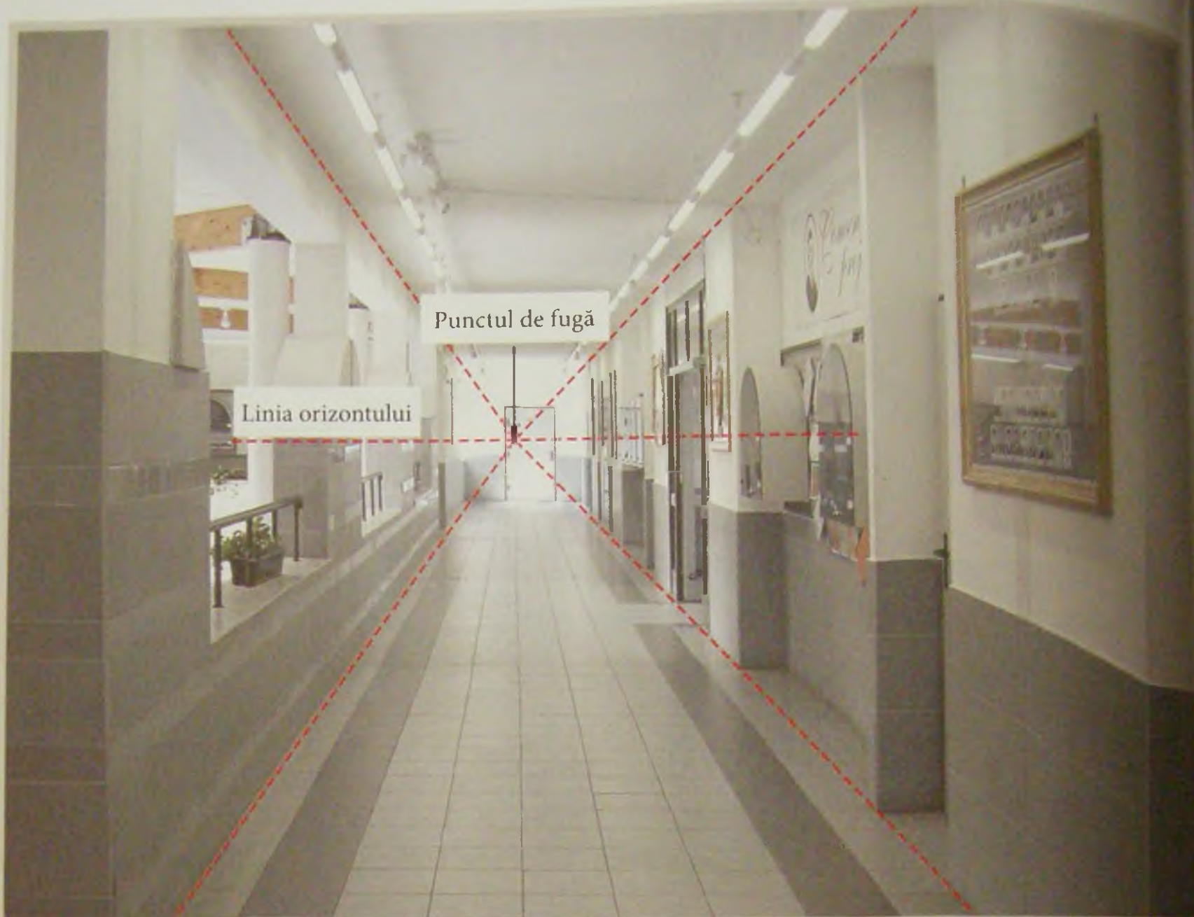
Reprezentarea liniei orizontului și a punctului de fugă pe imaginea coridorului dintr-o școală
